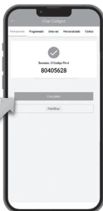
18 – O aplicativo fornecerá um código PIN que deve ser utilizado em até 24 horas. Após a digitação do código, pressionar # para confirmar.
