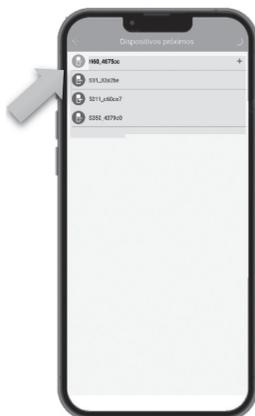
10 – O aplicativo irá apresentar a fechadura na forma do ícone ativo. Caso existam outras fechaduras já configuradas próximas, elas irão aparecer na forma de ícones inativos. Ao selecionar o ícone ativo, a fechadura irá informar em português “Administrador inserido com sucesso”.
