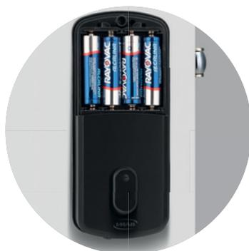
*Alimentada por baterias ( 4 pilhas AA ), emite sinal sonoro e visual quando as mesmas estiverem fracas. Caso as pilhas se esgotem, a fechadura poderá ser aberta pela chave mecânica inclusa ou alimentada pela energia de conector micro USB ( não incluso ) para ser acionada pelos outros acessos disponíveis.*
